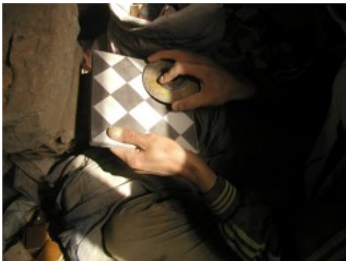
Se realizó un ensayo de resistencia a la abrasión sometiendo a varias baldosas al rozamiento de un disco de piedra de 50 mm y se llegó al resultado de un coeficiente de 21,2, que es muy superior al comportamiento del mármol,-
